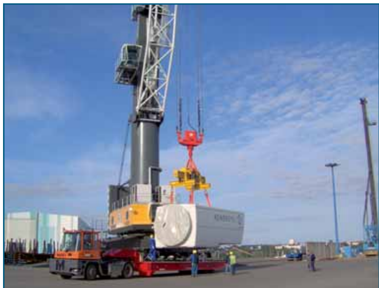
Verladung von Segmenten für Windkraftanlagen mit Hafenequipment
